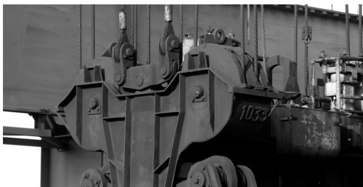
Bij de grote hijskranen van Tata Steel worden de snaarwielen gebruikt om een heel zwaar gewicht te kunnen tillen.
